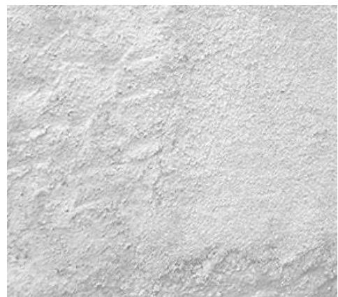
Slika 3: apneni špric (obrizg) iz peska in NHL 5 apna
